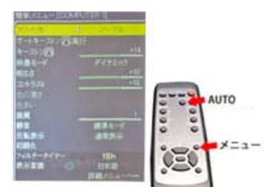
6 メニュー・リモコンでの調整、キーストーン(台形補正)、AUTO(画面位置) 手動での調整フォーカス(ピント)、ズーム
