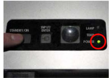
3 電源ボタンを押すとPOWERが緑色に点滅し起動します。POWERが緑色に点灯したらスタンバイOKです。
