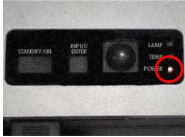
2 ACケーブルを差し込むと、POWERがオレンジに点灯します。
