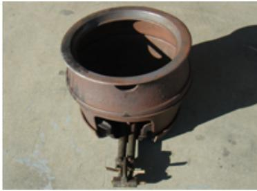
7 釜の大きさに合わせてチンカラカマド上部に外輪、内輪を設置します。
