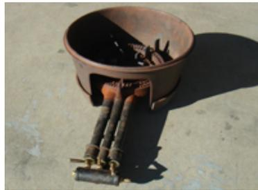
5 ※ガスコンロ(特大)を使用する際は、コンロのガワを外した状態で設置します。
