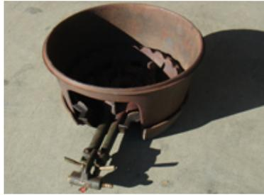
4 バーナー部をチンカラカマドの穴に通して設置します。
