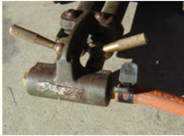
8 バーナーにガスホースを取付け、止め具で固定します。
