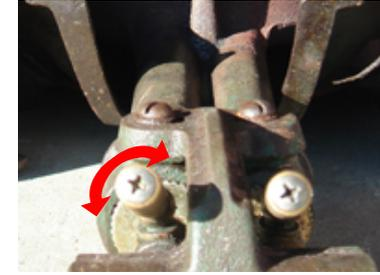
12 空気の調節は空気調節器を左右に回して行ないます。
