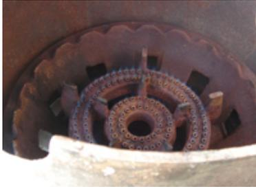
10 ガスコックを5秒程度開いて点火をし、空気の調整をします。
