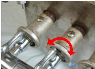
8 空気の調節は空気調節器を左右に回して行ないます。
