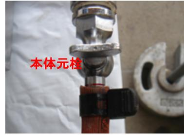
3 焼鳥器本体の元栓が『閉』の位置になっている事を確認して、ガスホースを取付け、止め具で固定します。
